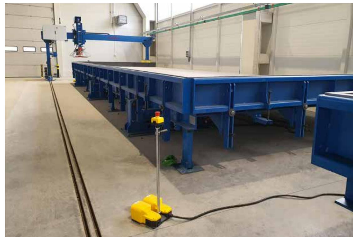
Гидравлические приводы оснащены предохранительным клапаном против падения. Гидравлическая система в сочетании с высокотехнологичным электронным управлением позволяет поднимать столы очень точно. Olnet Italy гарантирует выровненный подъем всех гидравлических цилиндров даже при децентрализованных нагрузках.
