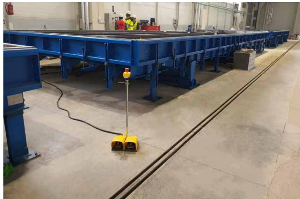
Длинные линии, пригодные для изготовления предварительно напряженных элементов, оснащены неподвижными и подвижными упорами натяжения. Передвижные упоры снабжены гидравлическими релаксационными цилиндрами. Для установки столов не требуется специального фундамента, а просто промышленный пол толщиной 350 мм. Упоры натяжения снабжены защитными клетками для защиты от прядей.
