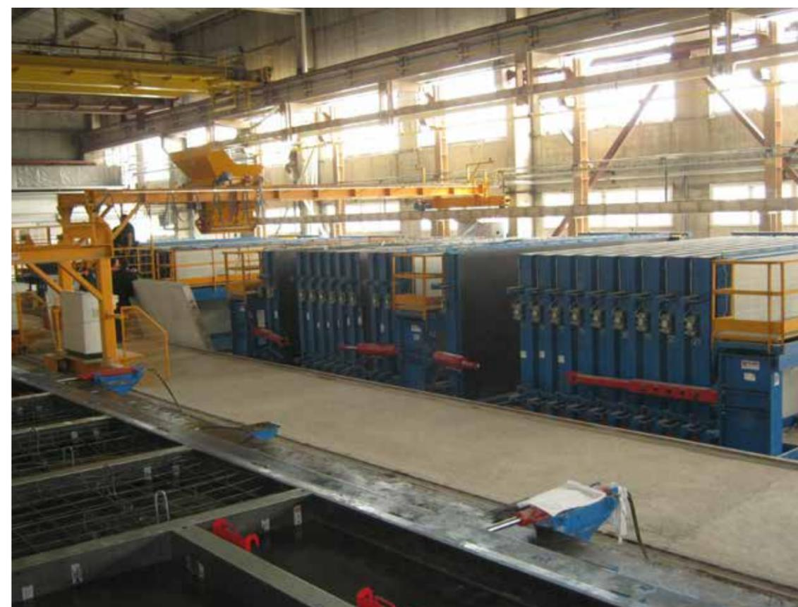
Вертикальная распалубка изделий происходит очень быстро, благодаря автоматическому перемещению боковых опор. Каждый отсек заливки для операций распалубки и подготовки к заливке может быть открыт до 2 м. (В соответствии с конкретным запросом клиента). Таким образом, оператор работает безопасно и удобно.
