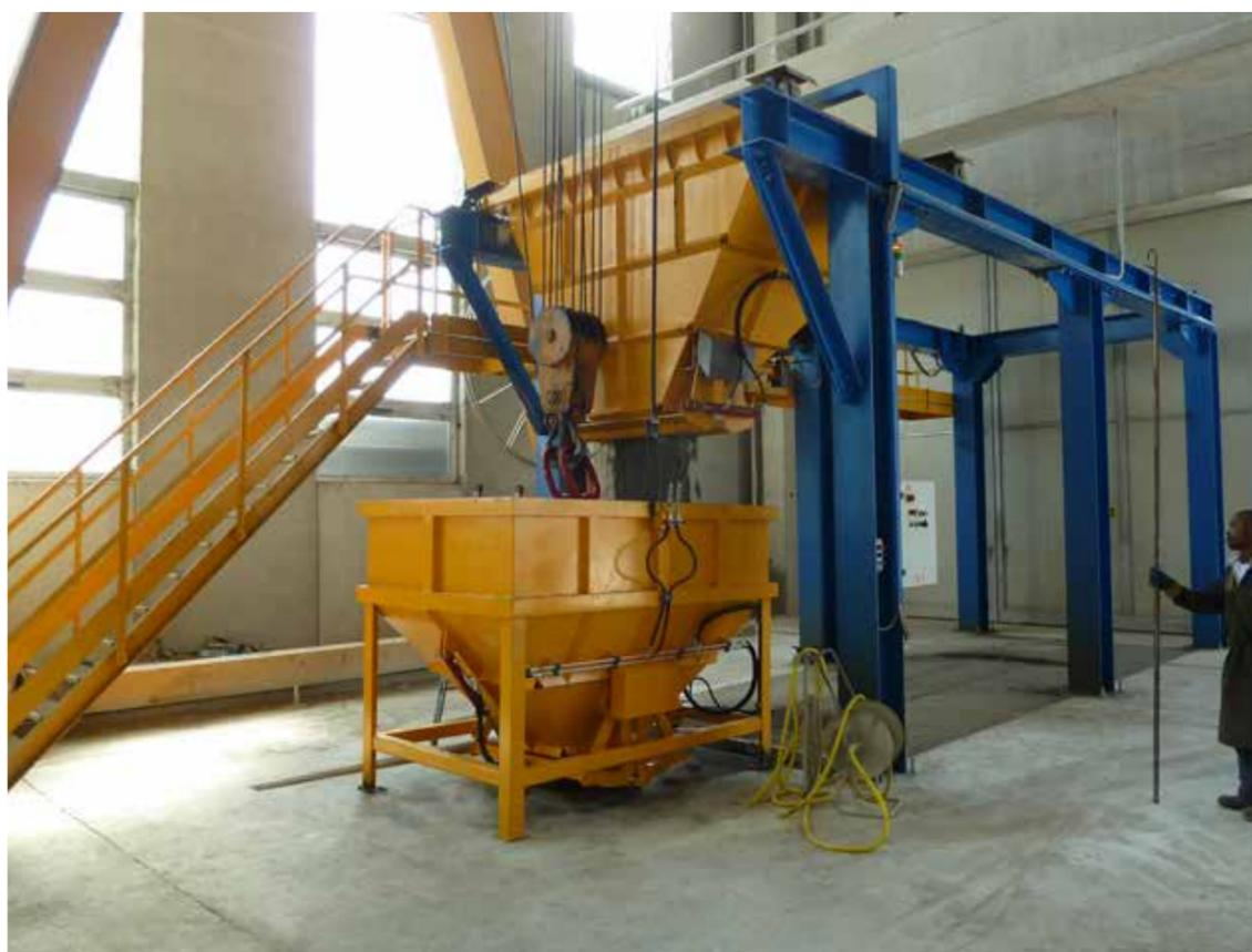
Бадья установлена на борту электрического мостового крана изготовлена из Н-образной двухбалльной структуры. Электрический кран может быть:
