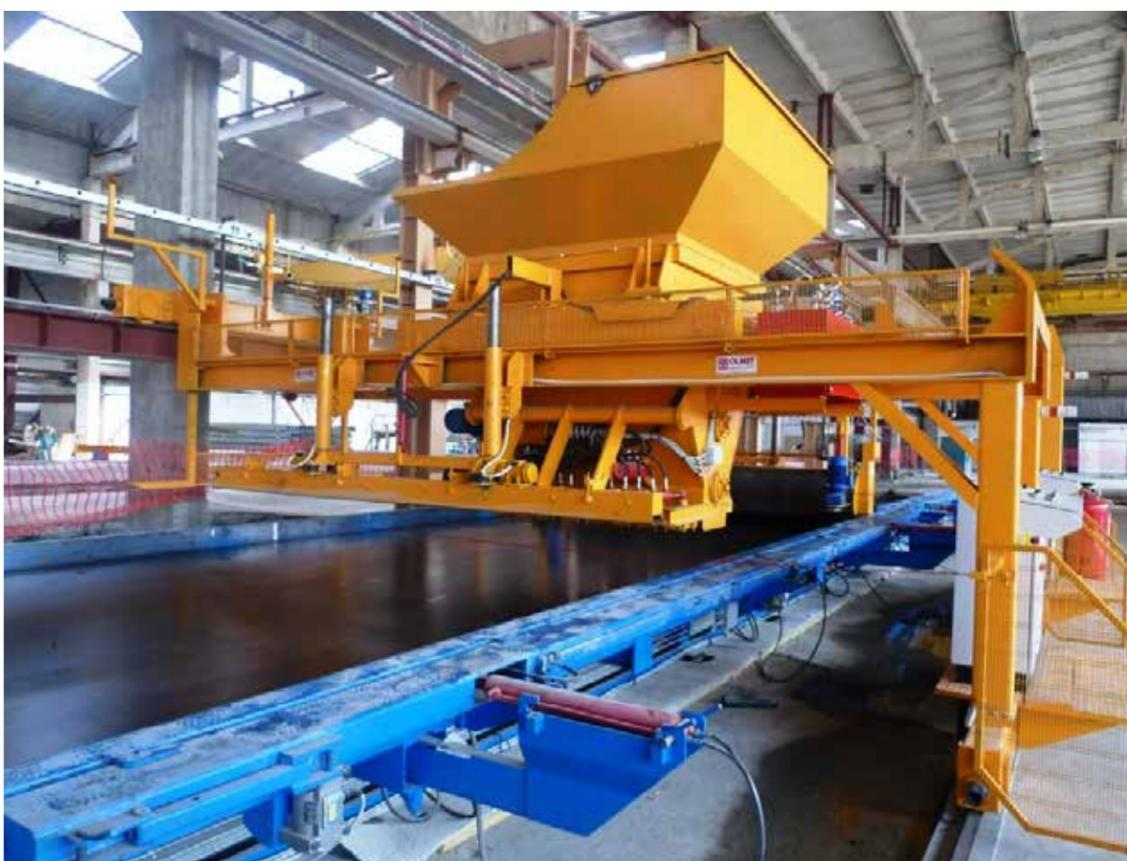
Моторизованные поперечные тележки перемещают поддоны поперек вдоль линии. Пара моторизованных тележек устанавливаются под поддоны. 4 гидравлических центра поднимают производственный поддон и транспортируют его на боковую производственную станцию. Затем поддоны снова опираются на скользящие колеса. Перемещенный поддон и тележки могут свободно выполнять дальнейшие транспортные операции.
