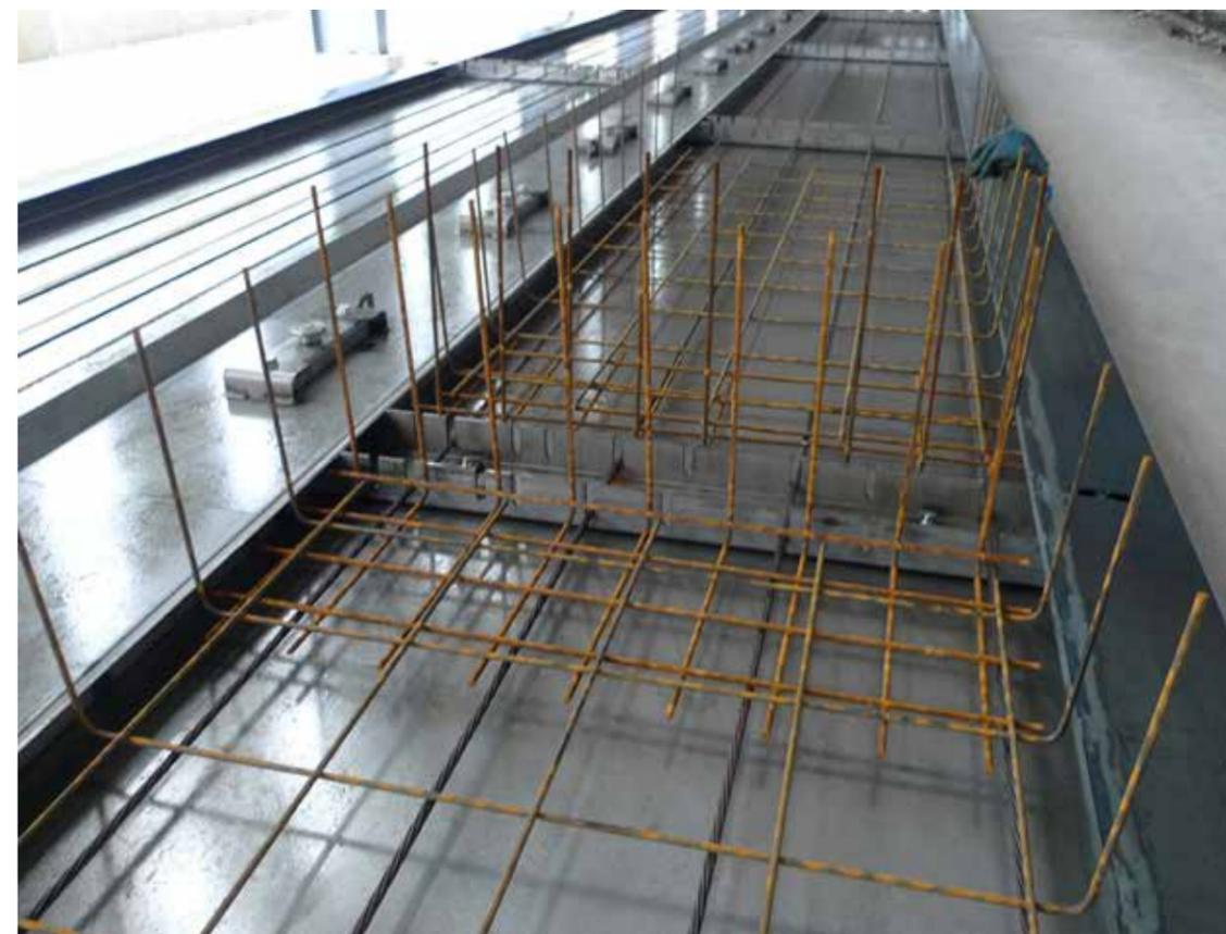
Поперечные балки могут быть просверлены для установки стальных труб, необходимых для установки ускоренного созревания бетона (опция). Трубы, соединены змеевиком и испытаны при максимальном рабочем давлении 10 бар. Все это изолировано экструдированным полистиролом с закрытыми ячейками, изготовленным с использованием экологически чистого расширителя. Соединения входа и выхода определяются с клиентом.
