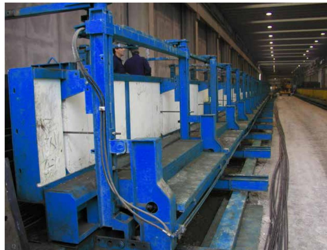
Система обычно состоит из активного упора натяжения (с расслабляющими цилиндрами, подвижным упором) и пассивного упора натяжения (фиксированный упор). Универсальные дорожки предназначены для крепления боковых опалубок, необходимых для формирования изделия.
