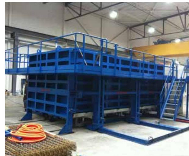
Кантователь всегда поставляется в комплекте со специальной гидравлической установкой, которая подходит для управления 4 + 4 телескопическими цилиндрами для подъема.
