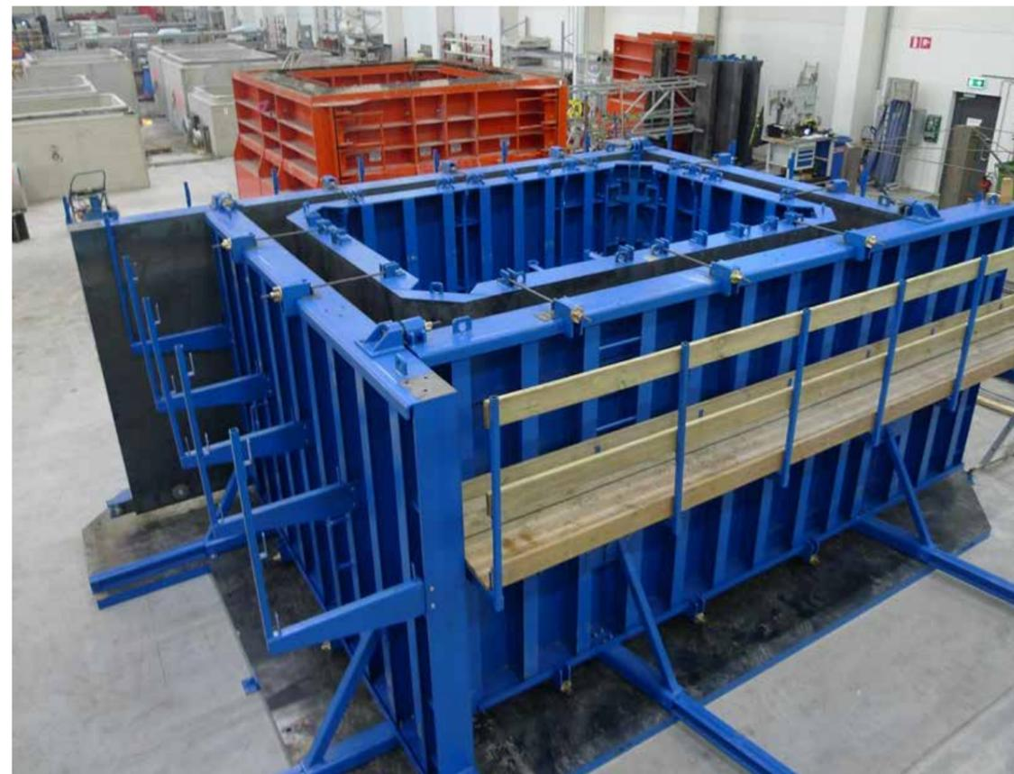
Верхние и нижние блокировки между опалубкой и наружными бортами с помощью быстро отвинчивающихся и навинчивающихся разделительных стержней dividag.
