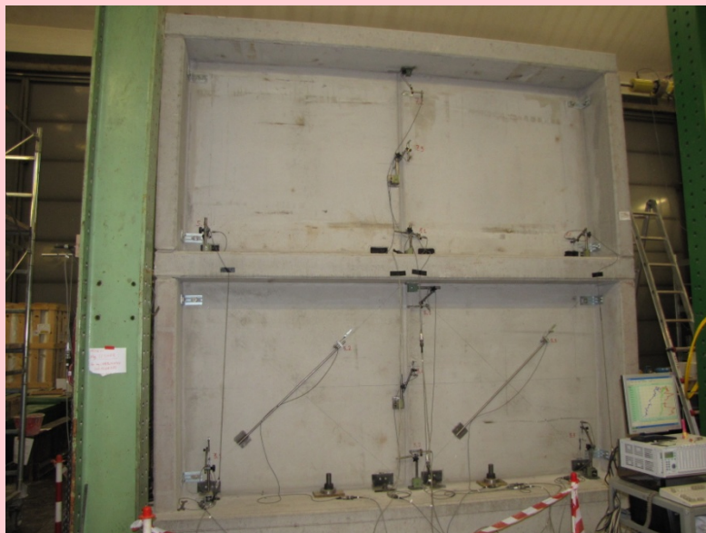
Figura 5: Allestimento per prova di carico sul set di pannelli
